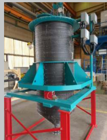
Behälter mit mineralisolierten Heizleitungen beheizt..... Vessel heated by mineral-insulated heating cable.....
